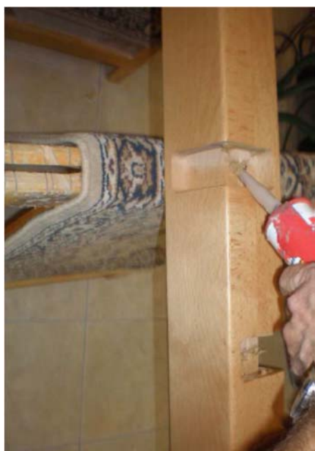
26b. Ausfräsung Pfosten einstreichen
